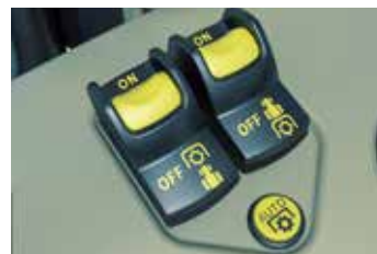
PTO セレクタースイッチとオート PTO ボタン (左はフロント PTO 用スイッチ)
